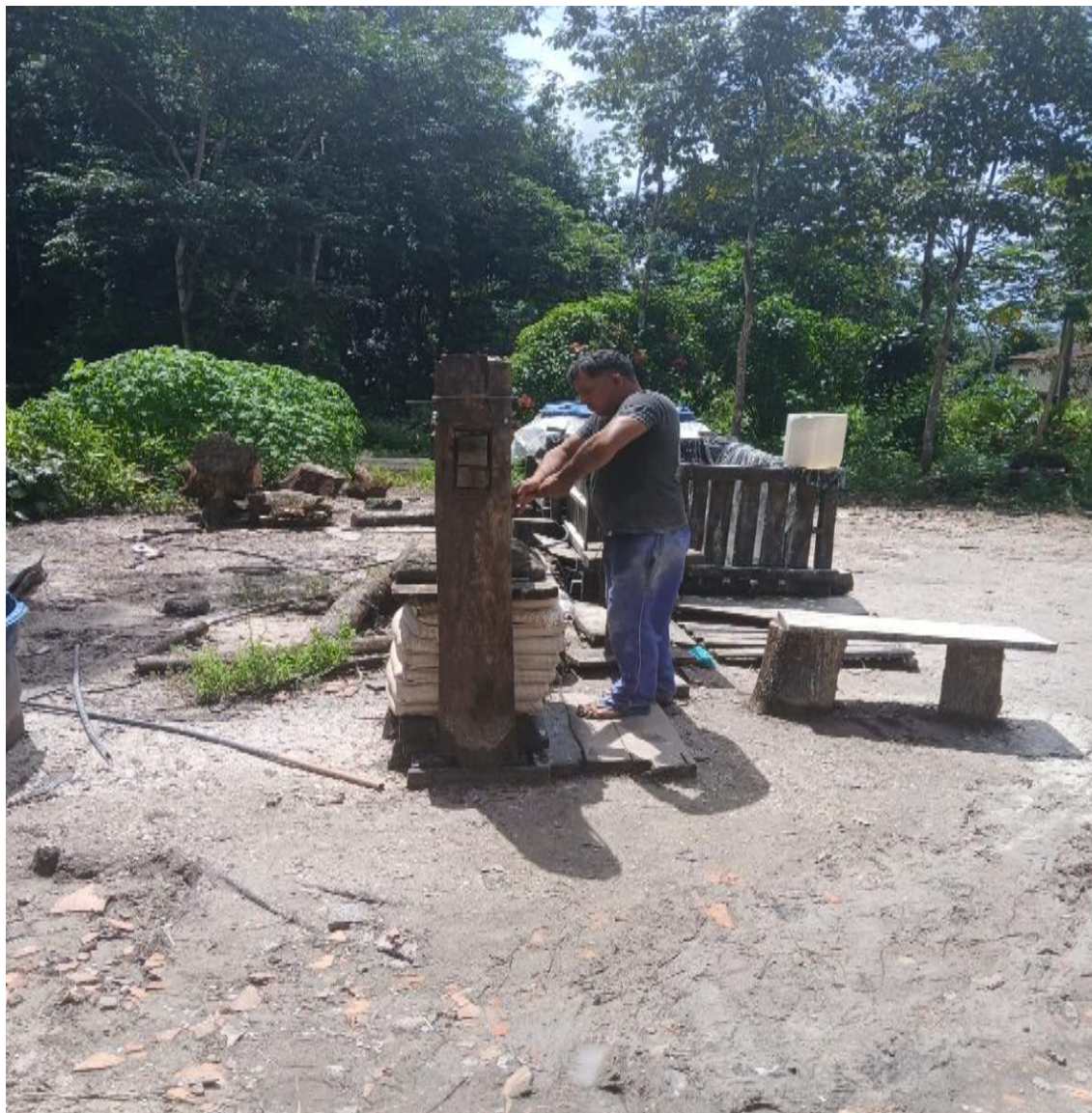
Figura 6 - Etapa de prensagem da massa de mandioca durante o processo de produção da farinha na comunidade quilombola Tipitinga.
