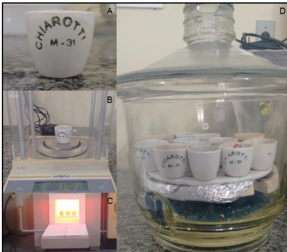
Figura 29 – Cadinho de porcelana (a); balança analítica de precisão (b); forno elétrico do tipo mufla (c); dessecador (d).
