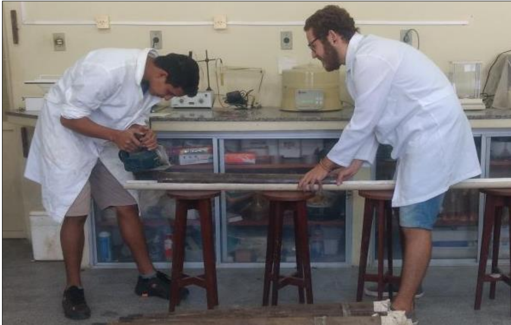
Figura 26 – Abertura do testemunho com auxílio de serra elétrica. Fonte: Autora.
