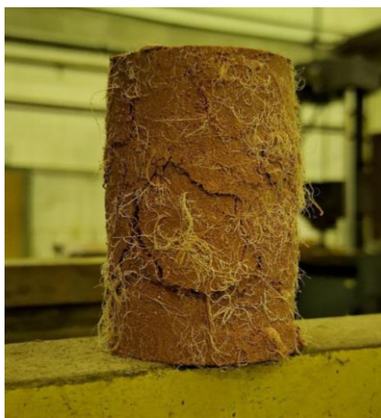
Figura 7: Corpo de prova com adição de fibra após ruptura.
