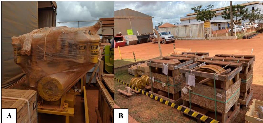
Figura 38. Motor Diesel (A) e Trucks (B) em região externa ao galpão de armazenamento. Trucks (B) sem isolamento adequado e com marcas de oxidação.
