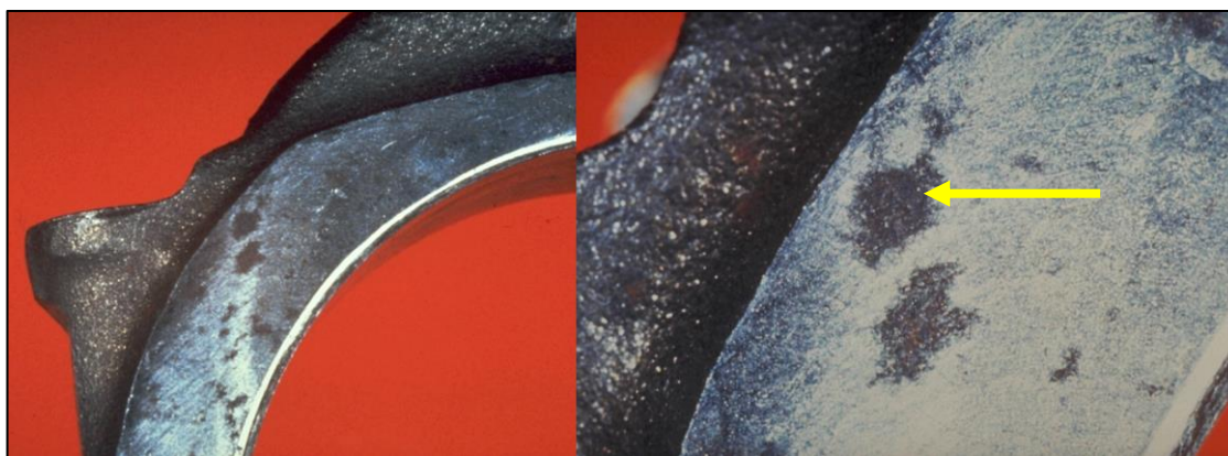
Figura 15. Biela de um motor com marcas de corrosão por pites
