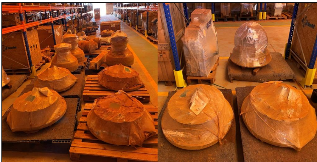
Figura 45. Medida de isolamento aplicada aos componentes armazenados no galpão.
