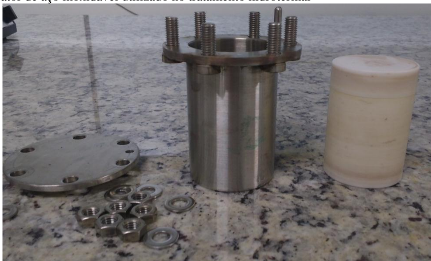
Figura 18 – Reator de aço inoxidável utilizado no tratamento hidrotermal
