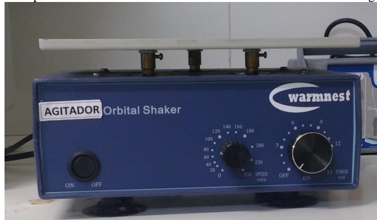
Figura 17 – Agitador do tipo orbital utilizado durante a fase de envelhecimento da sílica gel
