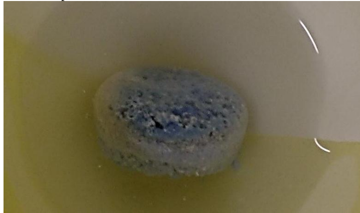
Figura 19 – Produtos de síntese após a fase de tratamento hidrotermal
