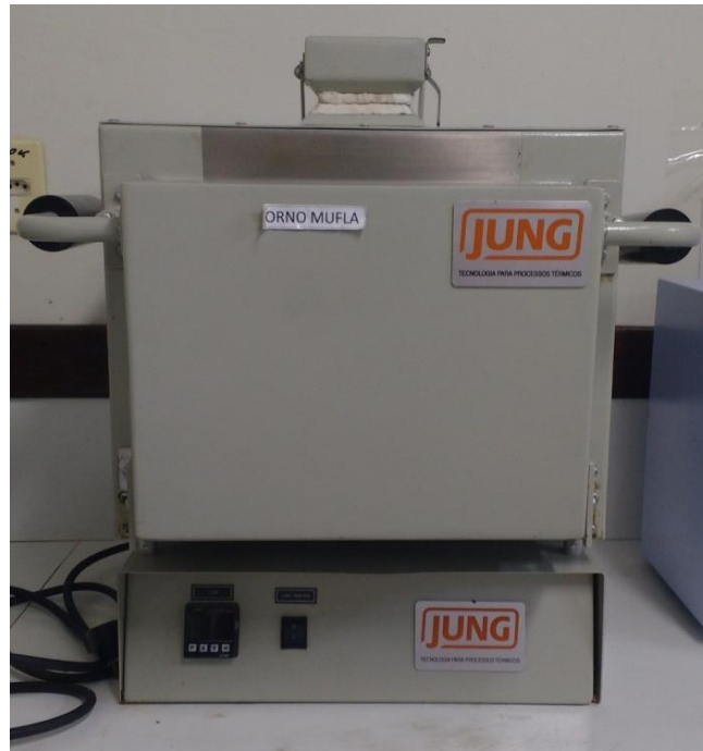
Figura 16 – Forno Mufla utilizado na etapa de calcinação
