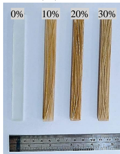
Figura 19 – Corpos de prova epóxi-caranã de 0, 10, 20 e 30 % vol de fibras de caranã para ensaio de flexão
