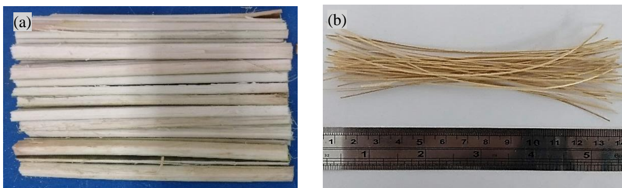
Figura 10 – Fibras de caranã (a) Tala de caranã e (b) Fibras de caranã
