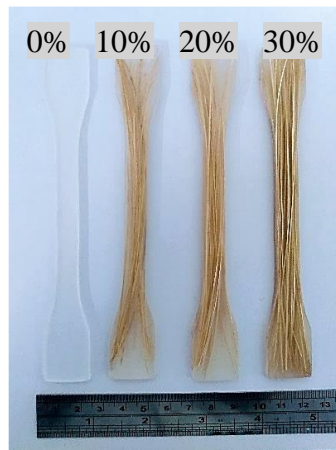
Figura 16 – Corpos de prova epóxi-caraná de 0, 10, 20 e 30 % vol de fibras de caraná para ensaio de tração
