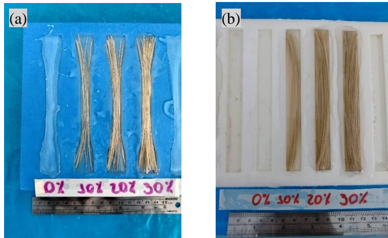
Figura 13 – Produção dos compósitos para (a) Ensaio de tração e (b) Ensaio de flexão
