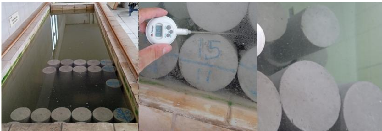
Figura 5: Cura dos corpos-de-prova de concreto
