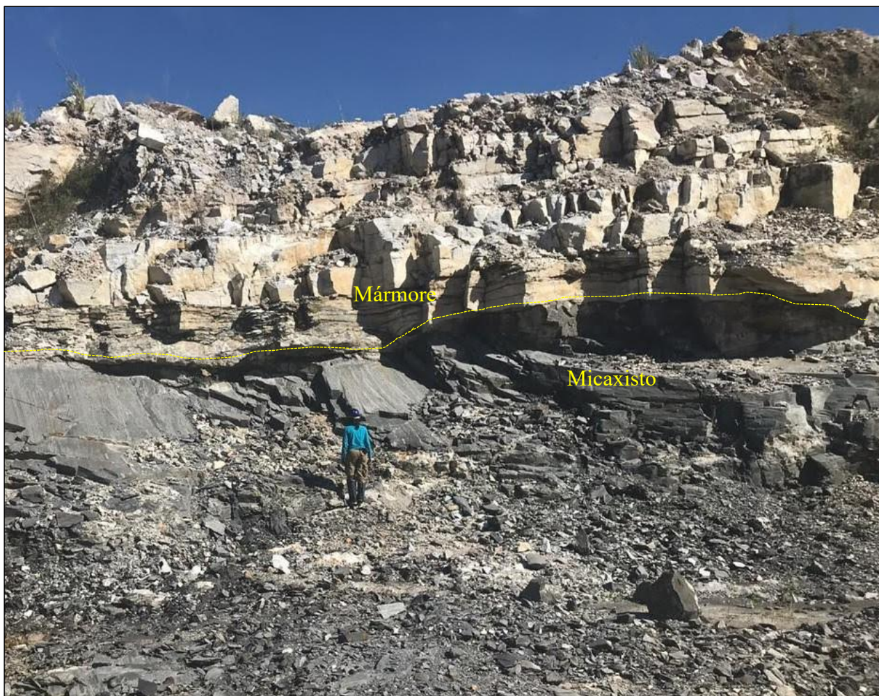
Figura 8 - Detalhe do contato entre micaxisto e do mármore da Formação Xambioá, dentro da área de exploração da empresa Minerax.
