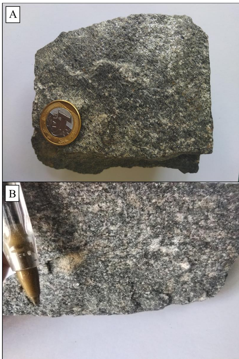
Figura 10 - Exemplos de micaxisto da Formação Xambioá. A) Amostra de rocha com dobras pegmatíticas formando ângulo agudo com a xistosidade, indicando diferentes pulsos de deformação. B) Detalhe da granulação gradacional da rocha com cristais de diferentes tamanhos (variando de fino a médio).
