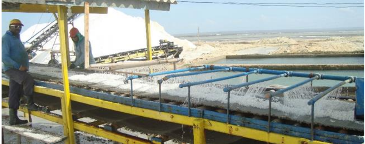
Figura 7- Monitoramento realizado por operários na esteira do sistema de lavagem de sal em salinas de empresa de pequeno porte da Região de Macau – Rio Grande do Norte.
