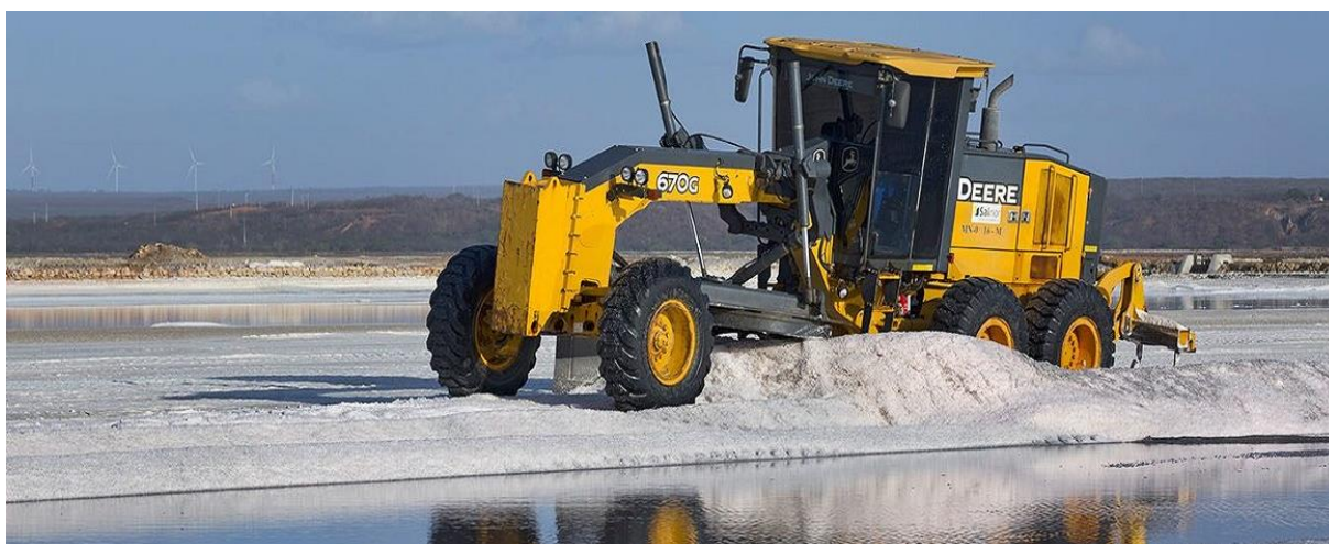
Figura 6- Detalhe da motoniveladora 670G utilizada na coleta de sal da empresa Salinor – Salinas do Nordeste no Rio Grande do Norte. Fonte: Veneza Equipamentos (2018).
