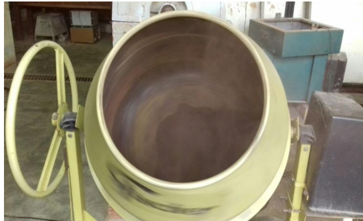
Figura 31 - Betoneira usada na micropelotização.
