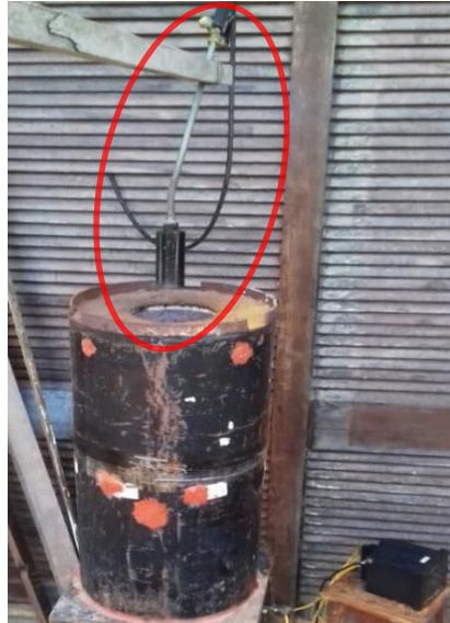
Figura 22 - Sistema de ignição com o maçarico na região superior do reator de leito fixo.
