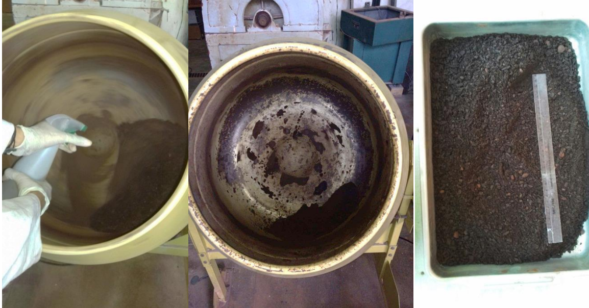
Figura 28 - Processo de micropelotização para determinar o teor de umidade ótima.
