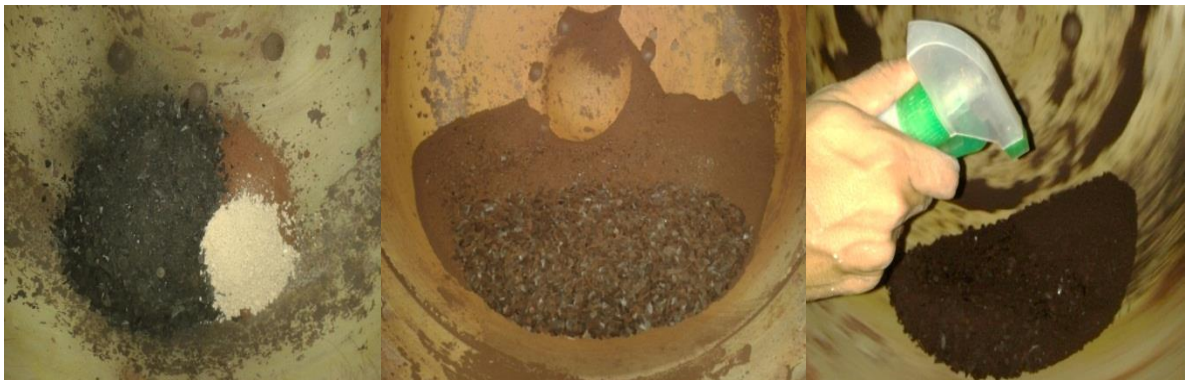
Figura 30 - Micropelotização das matérias-primas.
