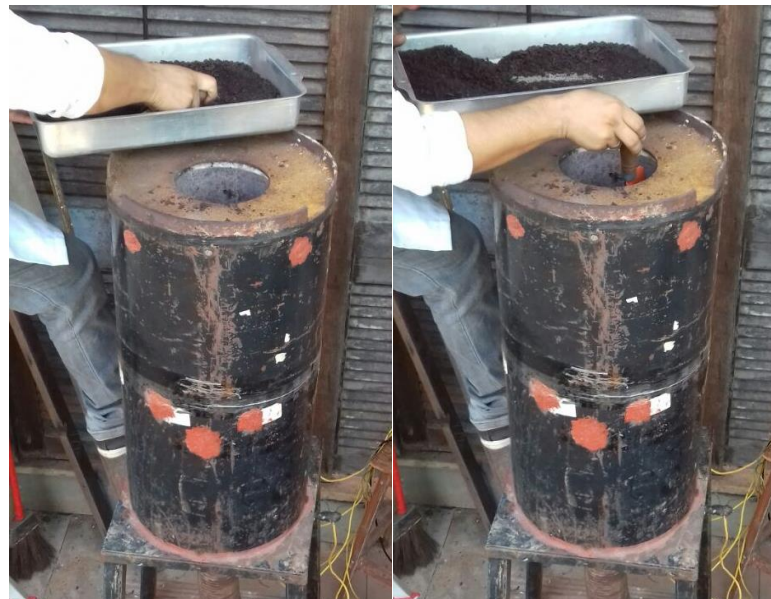
Figura 33 - Abastecimento do leito com o material pelletizado.
