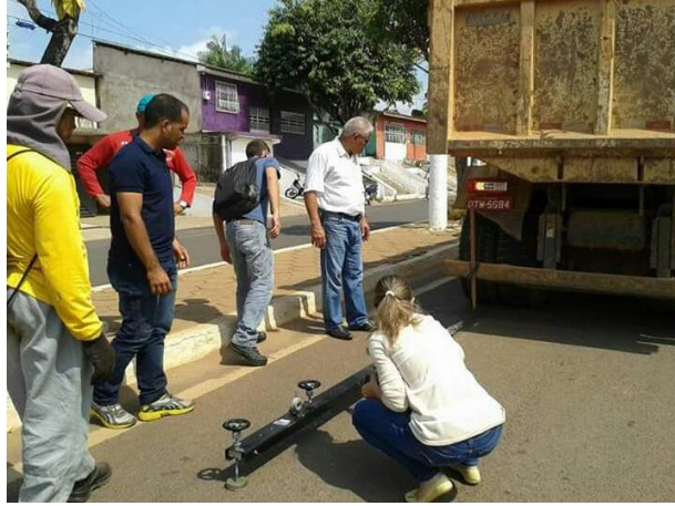
Figura 34 - Nivelamento da Viga Benkelman
