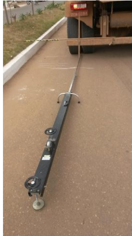
Figura 30 - Viga de Benkelman utilizada para os ensaios deflectométricos
