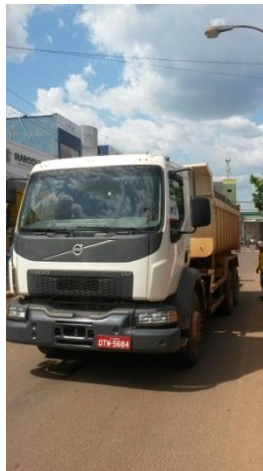
Figura 31 - Caminhão utilizado durante os ensaios deflectométricos
