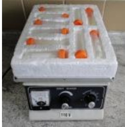
Figura 13. Ensaio de biossorção em mesa agitadora orbital Lab Liner shaker.
