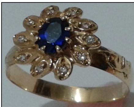
Figura 8: Cravação com garras Fonte: Elaborado pelo autor
