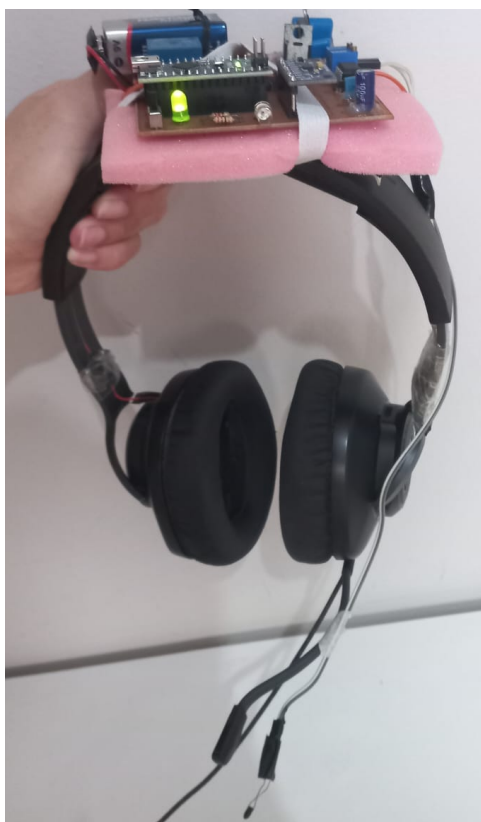
Figura 3.13 – Protótipo final fixado ao headset
