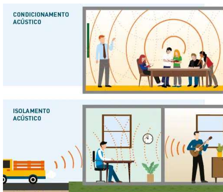
Figura 23- Isolamento e Condicionamento Acústico.
