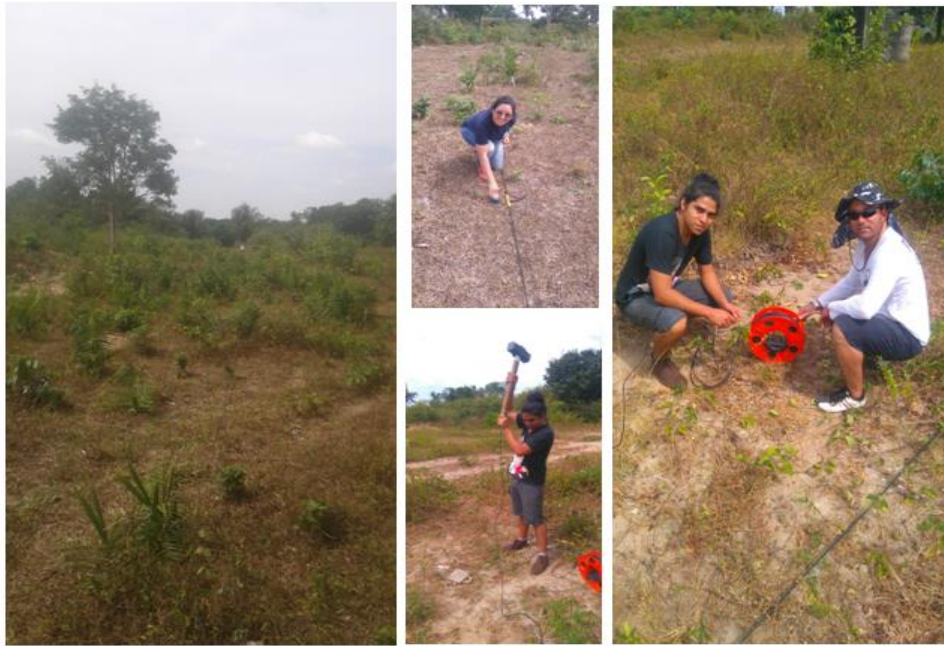
Figura 26 - Foto da linha do levantamento do Método de sísmica de Refração.
