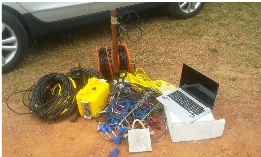
Figura 27- Foto do equipamento utilizado na aquisição sísmica de refração rasa.
