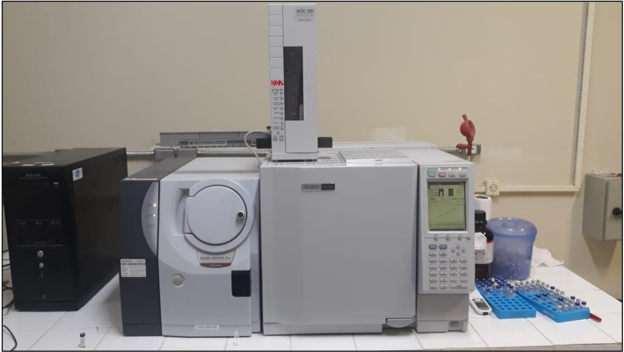
Figura10. Sistema de cromatografia gasosa acoplada a espectrometria de massa
