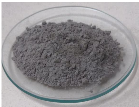
Figura 6 – Amostra de Escória de Alto Forno
