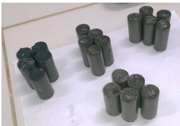
Figura 17 - Corpos de Prova da Pasta de Cimento Geopolimérico
