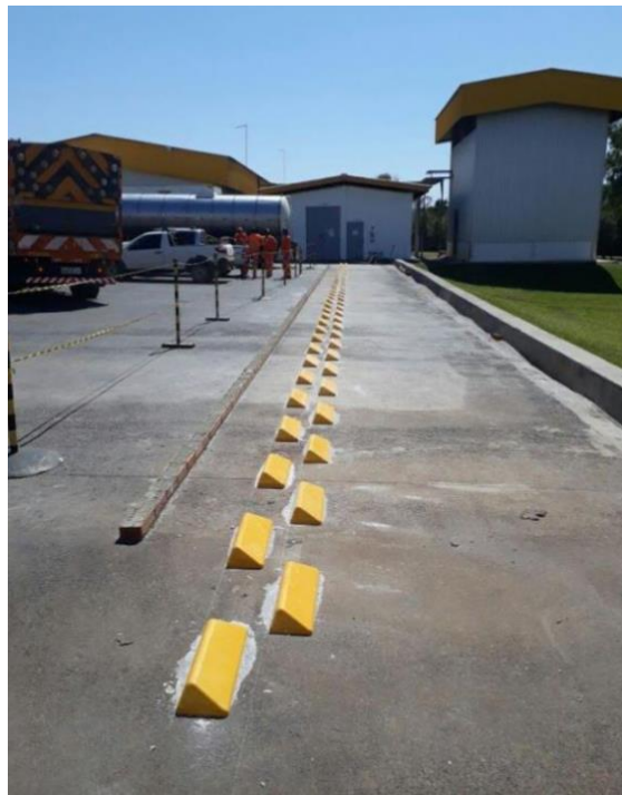
Figura 6 – Exemplo de sinalização do tipo tachão
