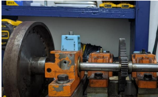
Figura 26. Acelerômetro fixado por parafuso no Mancal 1
