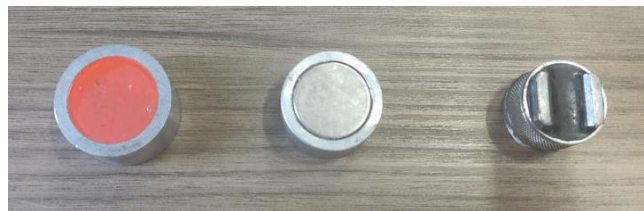
Figura 24. Superfície de contato das Bases magnéticas
