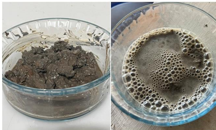
Figura 5: Processo de tratamento das amostras com H_2O_2 para eliminação de M.O.
