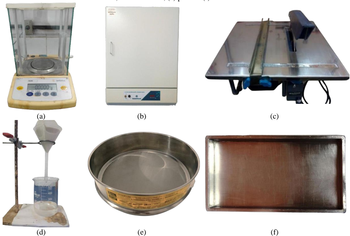
Figura 6 - Equipamentos utilizados: (a) balança analítica, (b) estufa, (c) máquina de corte, (d) suporte universal, funil e Becker, (e) peneira (f) molde metálico
