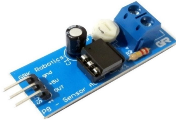
Figura 6 - Sensor de tensão GBK P8.
