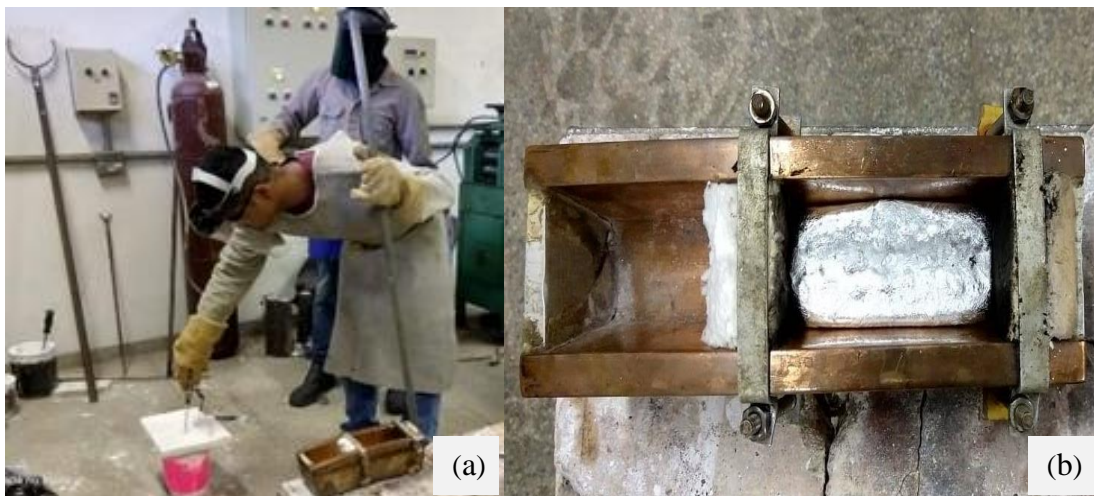
Figura 15 - Injeção de ar argônio (a) obtenção do lingote.(b)
