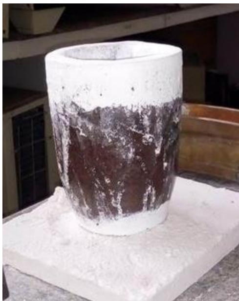
Figura 14 - Cadinho preparado para fundição.
