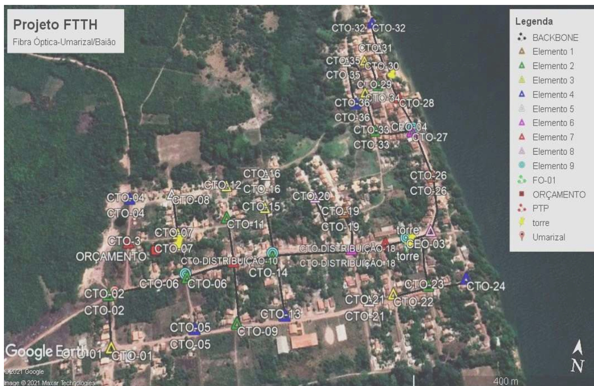
Figura 7 - Projeto para implantação de Rede Fibra Óptica na Comunidade Quilombola de Umarizal.
