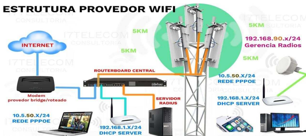
Figura 2 - Estrutura de Provedor via rádio.
