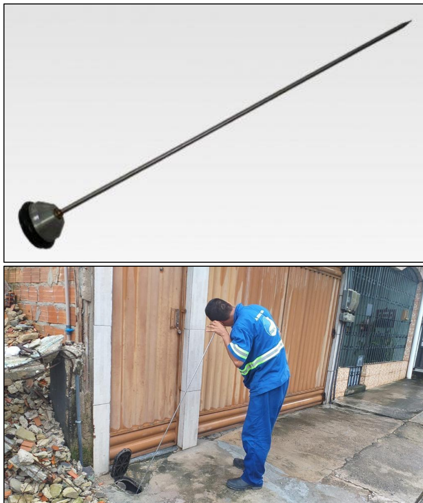
Figura 55 - Haste de Escuta Mecânica e sua Utilização Fonte: Autor
