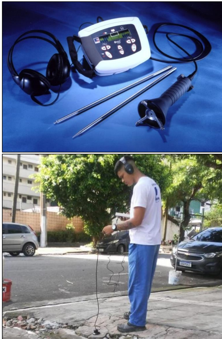
Figura 56 - Geofone Eletrônico e sua Utilização Fonte: Autor
