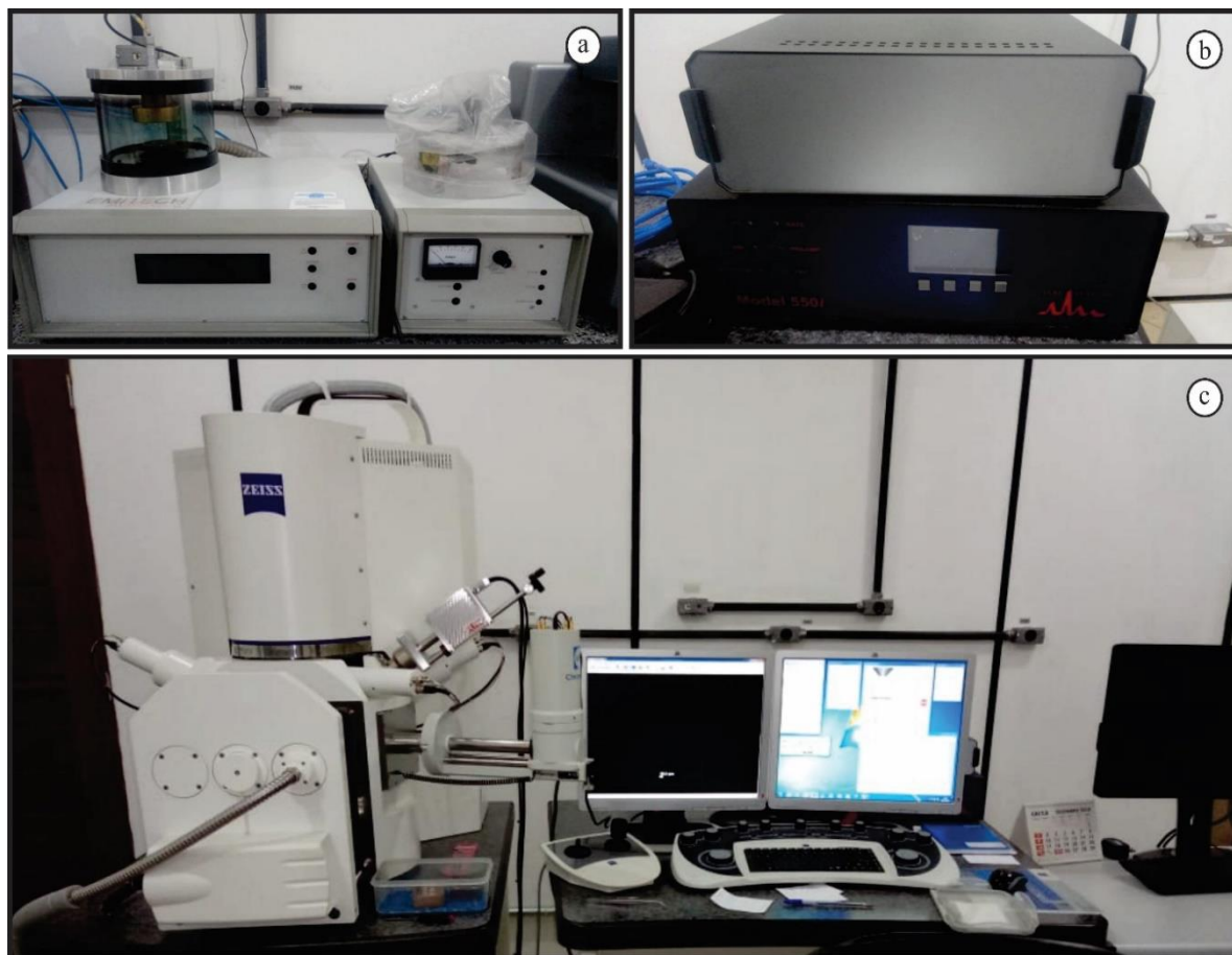
Figura 15 – (a) Metalizador; (b) Equipamento de EDS; (c) MEV
