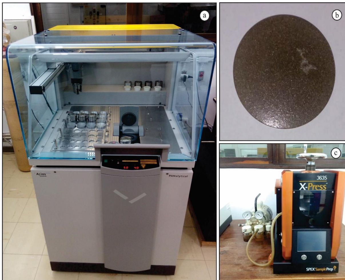
Figura 12 – (a) Espectrômetro de Fluorescência de Raios-X; (b) Pastilha prensada; (c) Prensa
