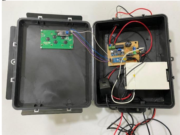
Figura 38 - Posicionamento do hardware na caixa hermética.
