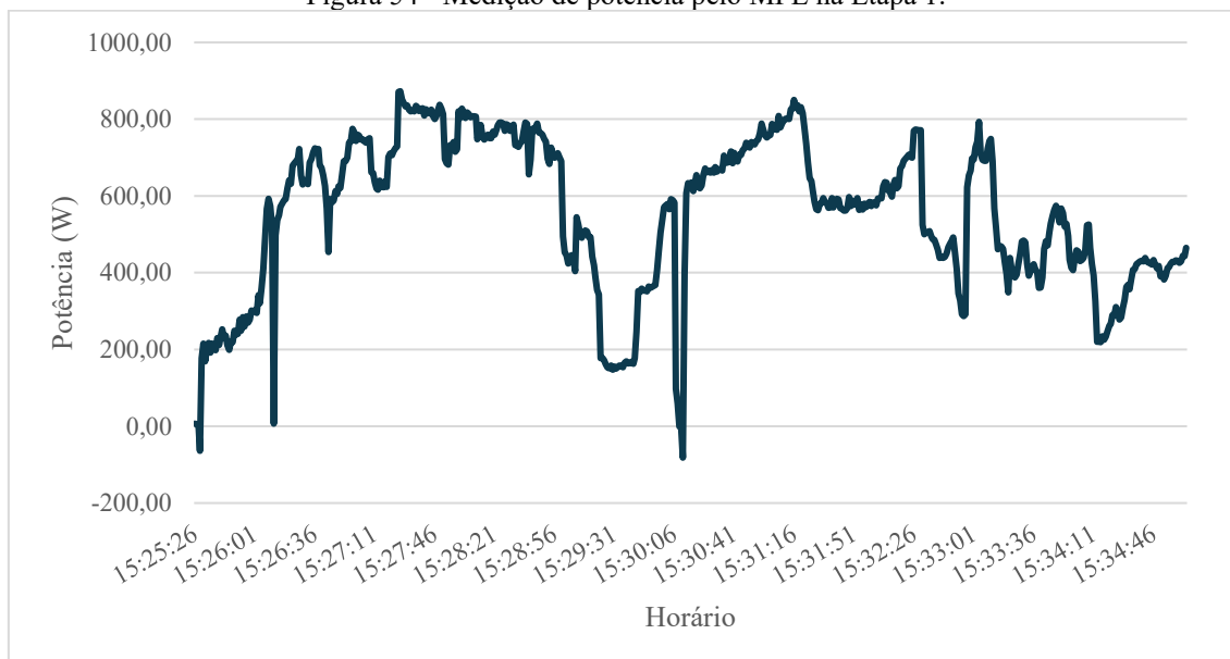
Figura 54 - Medição de potência pelo MPE na Etapa 1.
