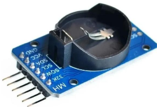
Figura 24 - Modelo de RTC utilizado.
