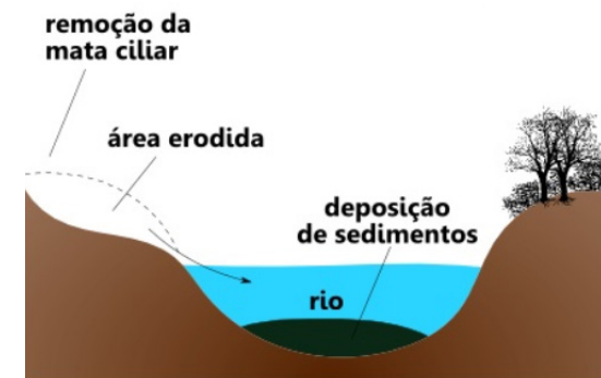
Imagem 112: Esquema mostrando a erosão causada pela retirada da vegetação das margens dos rios. Função: bioorbis.org, 2015.
