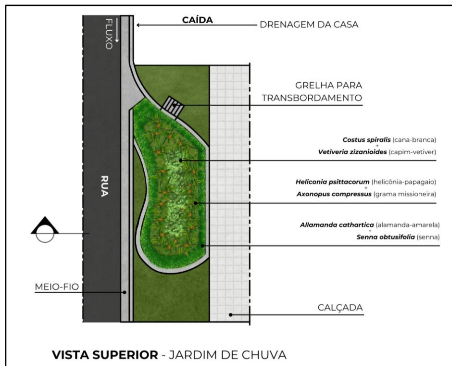
Figura 57 – Desenho esquemático de jardim de chuva com indicação das espécies e camadas de subsolo em vista superior.
