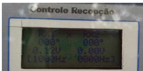
Figura 33 – Informações de frequência e amplitude de tensão no display do controle de recepção.
