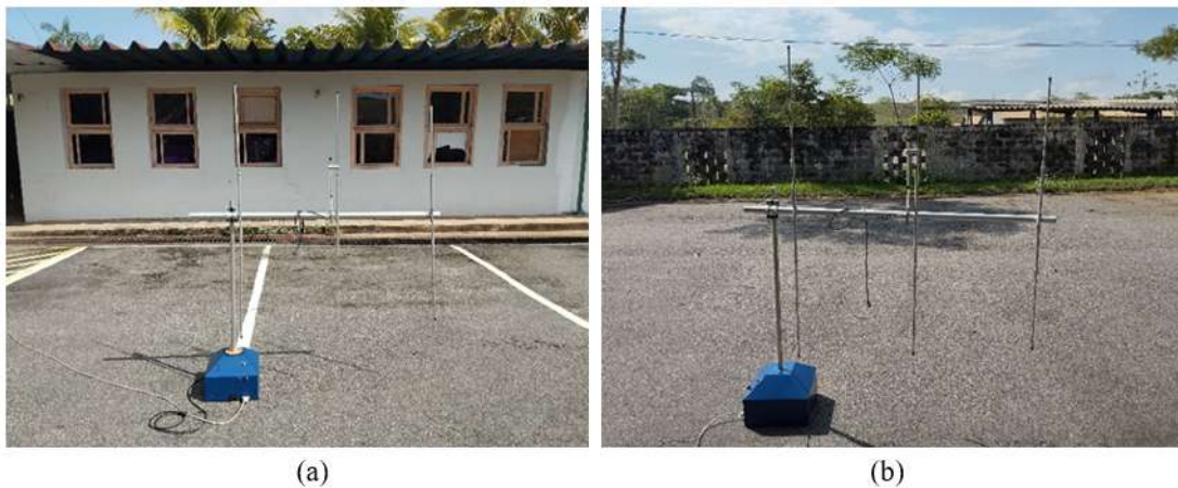
Figura 30 – Antenas montadas e posicionadas nas bases de transmissão; (b) recepção.
