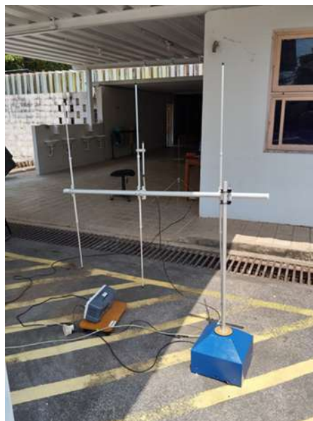
Figura 36 – Disposição da antena e conexão dos cabos à base de transmissão.
