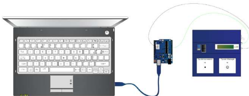
Figura 54 – Conexão entre o Arduino Uno e o painel de controle de transmissão.
