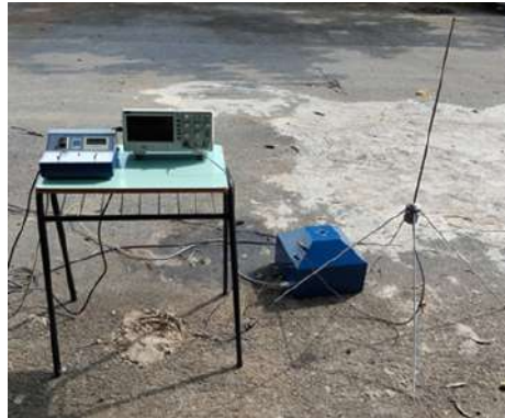
Figura 40 – Disposição da antena receptora.
