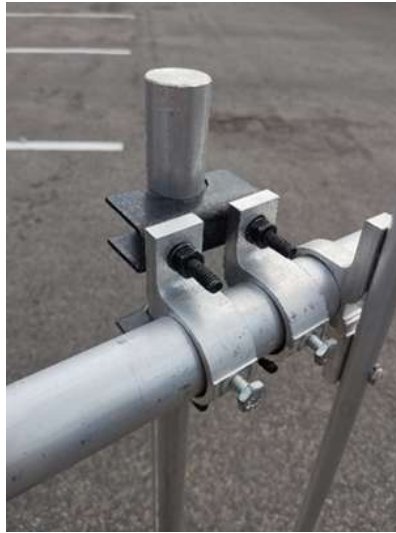
Figura 31 – Parafusos de fixação do suporte da antena no mastro de fixação.
