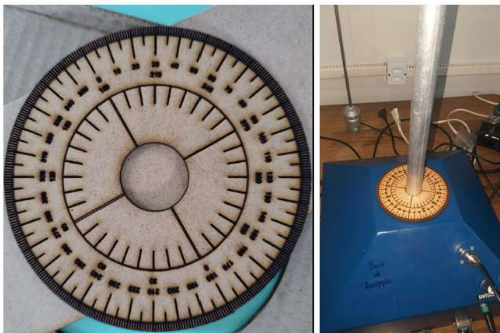
Figura 28 – Discos transferidores em mdf para medição de rotação.
