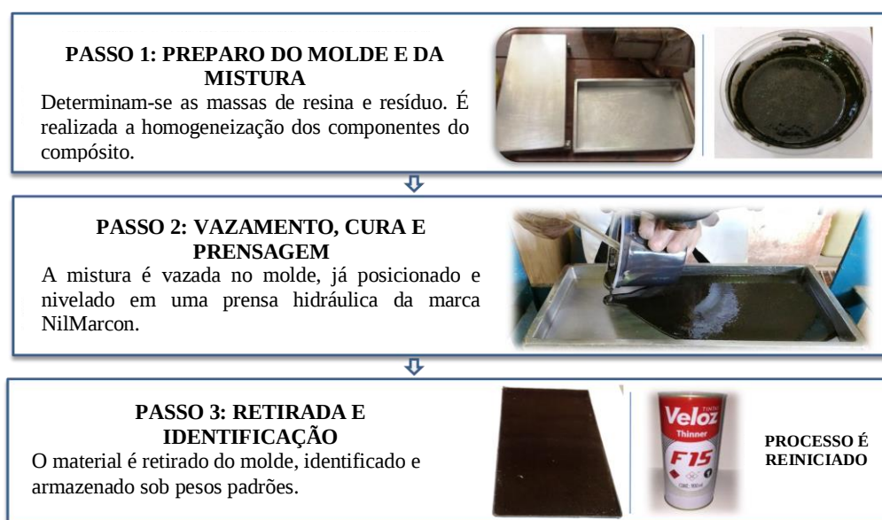
Figura 3.6 – Fluxograma de fabricação dos compósitos.
