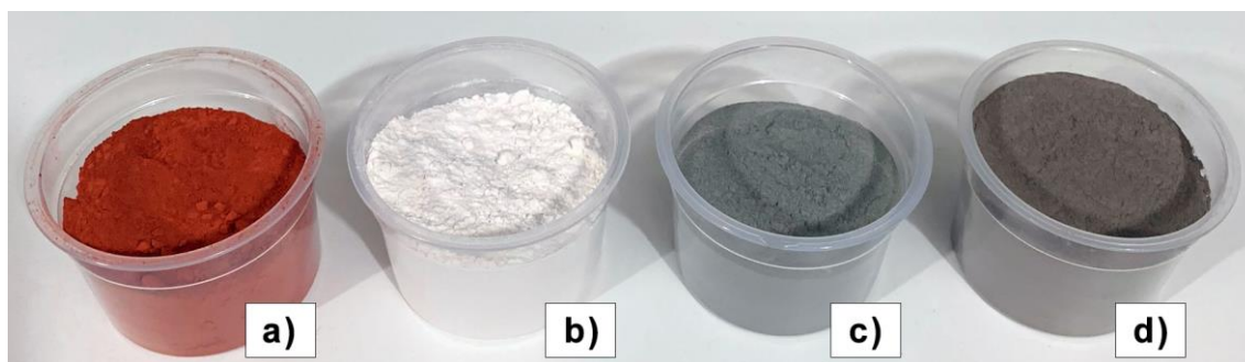
Figura 3.2 – Resíduos industriais após o processo de peneiramento: a) Lama vermelha; b) Caulim; c) Cobre; d) Cinzas volantes.
