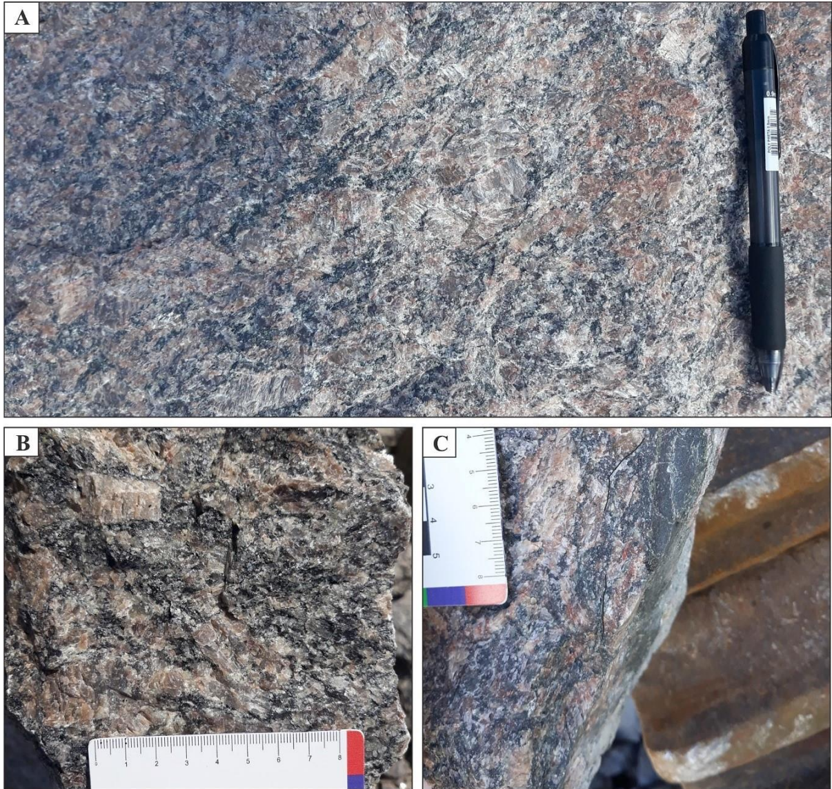
Figura 11- Aspectos gerais do biotita sienogranito JAP18-05. (A) Rocha porfirítica de composição sienogranítica, que destaca um estiramento local em cristais quartzo e orientação de biotita, definindo uma trama anisotrópica à rocha; (B) Fenocristais euédricos de microclínio de dimensões em torno de 2 a 3 centímetros; (C) Porções da rocha, especialmente a matriz grossa, incorporam um material afanítico seccionado de cor escura denominado de pseudotaquilito, que está associado a zonas de falhas em ambientes crustais rasos.
