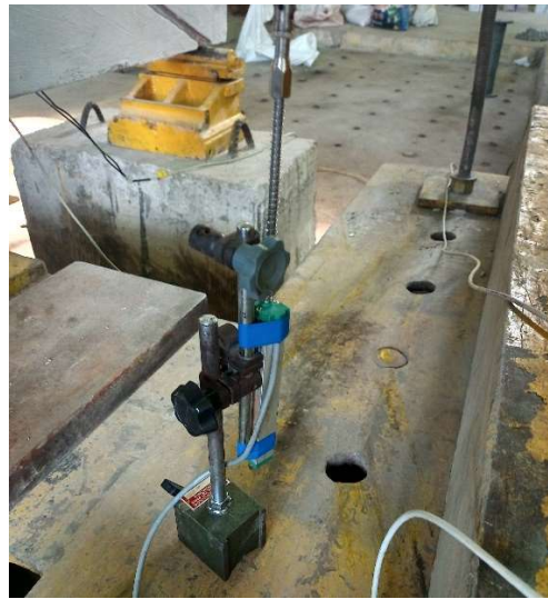
Figura 3.24: Régua potenciométrica sustentada por estrutura auxiliar com base magnética
