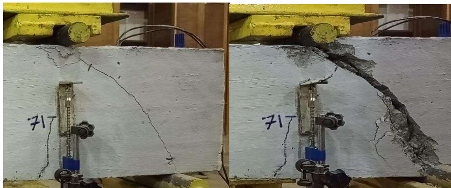
Figura 2.10: Fissura característica do efeito de arco durante o ensaio de cisalhamento em viga de concreto armado com estribos no LEC/UFPa, antes da ruptura (A) e após a ruptura (B)
