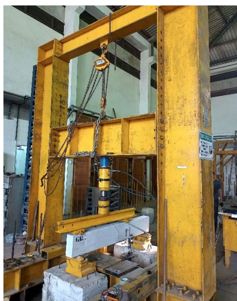
Figura 3.32: Sistema de ensaio após montagem completa, exibindo pórtico de reação
