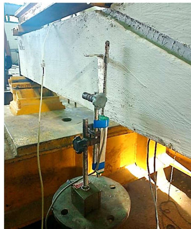
Figura 3.25: Régua potenciométrica sobre aparelho de apoio, posicionada na lateral de viga
