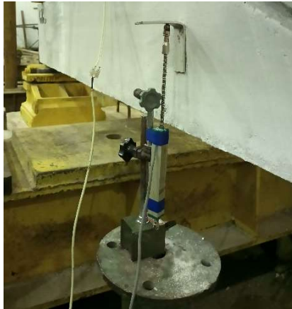
Figura 3.27: Cantoneira fixada na face lateral de viga, com régua potenciométrica sob a aba livre
