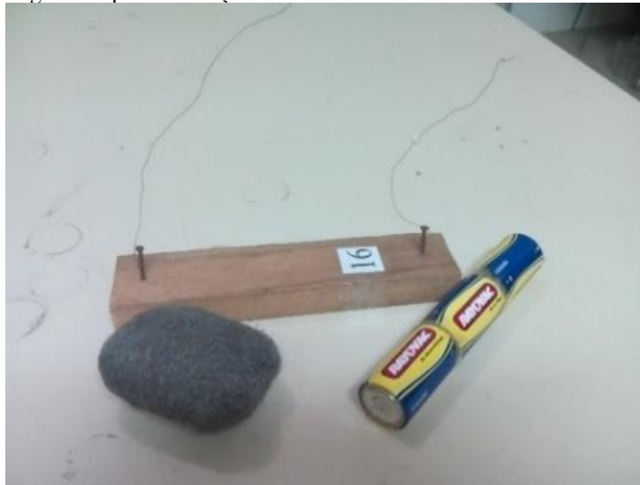
Fig.2 – A queima de aço
