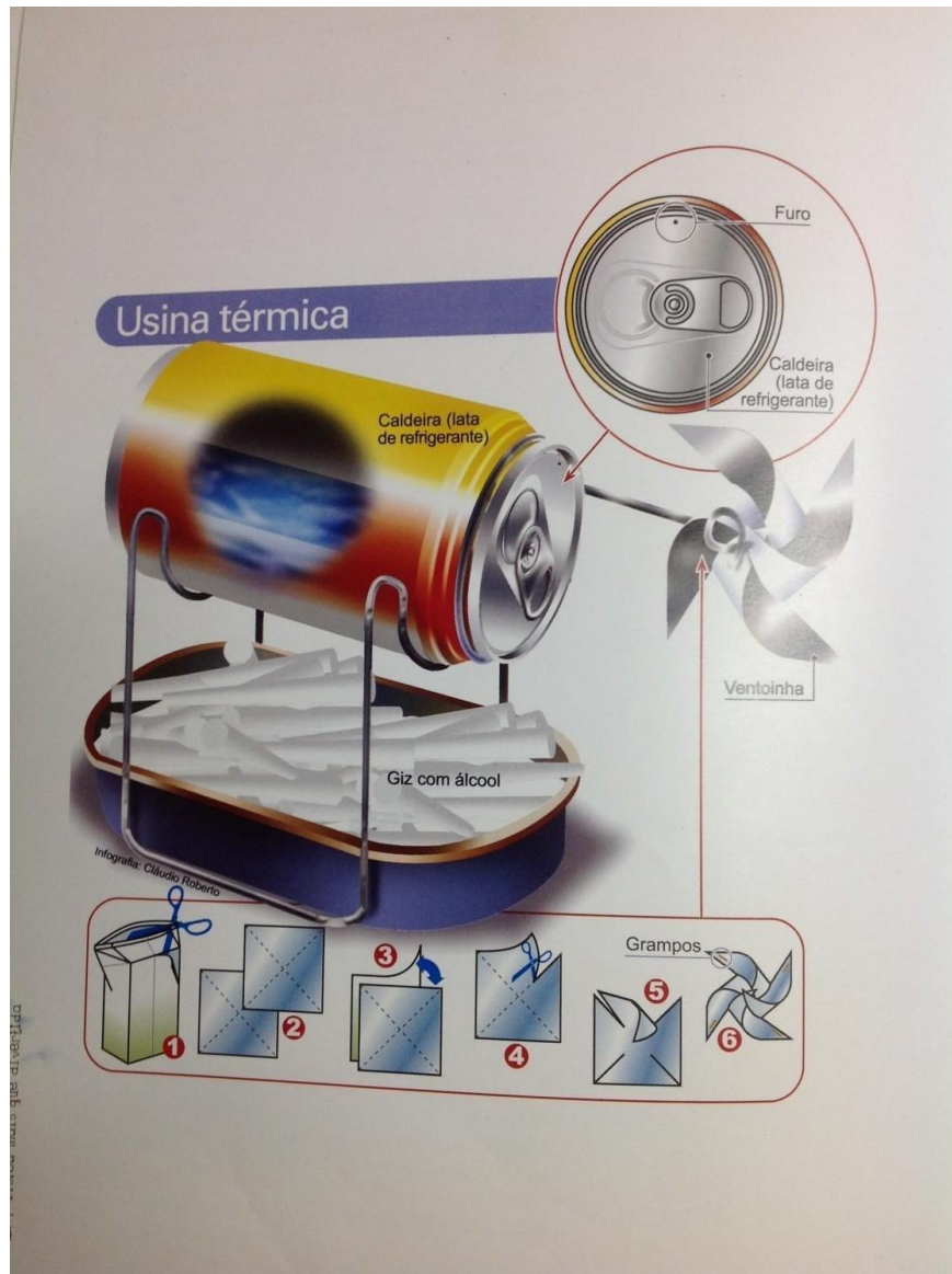
Figura 1 – Dispositivo experimental da usina térmica
