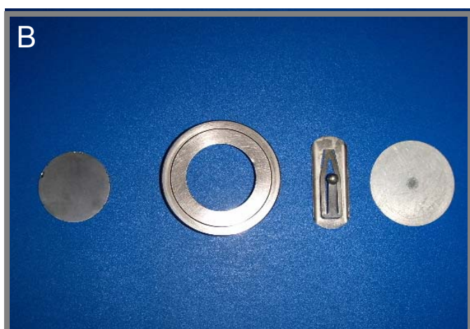
Figura 7: (A) Gral de ágata para pulverização das amostras. (B) Partes constituintes do porta-amostra de Si. (C) Porta-amostra de Si montado, contendo os cristais pulverizados.
