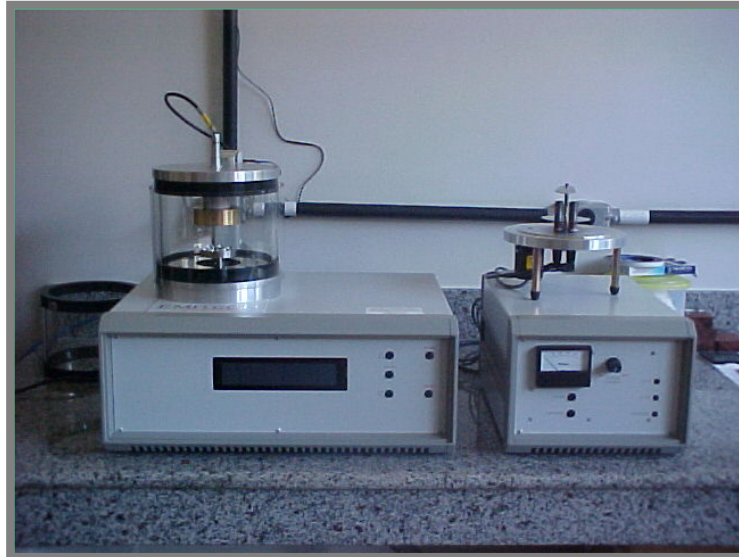
Figura 5: Sistema automático de metalização das amostras. Modelo EMITECH – K550XR®
