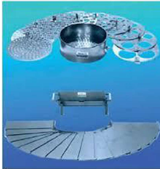
Figura 8 - Equipamento para determinação de índice de forma – crivo redutor
