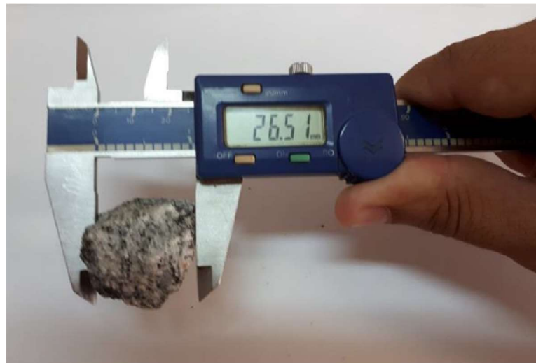
Figura 10 – Leitura da dimensão do agregado com o uso do paquímetro
