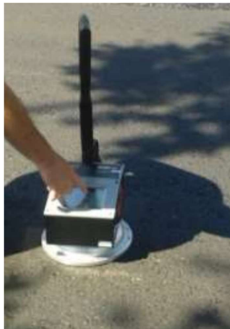
Figura 45 - Leitura do local com densímetro não-nuclear
