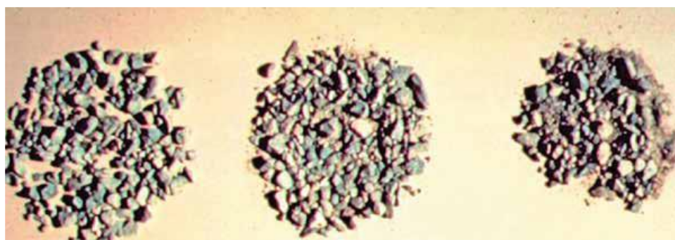
Figura 4 - Comparação de granulometrias de misturas asfálticas a quente
