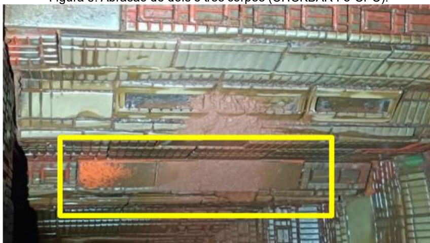
Figura 8: Abrasão de dois e três corpos (CHOKBAR Fe-Cr-C).
