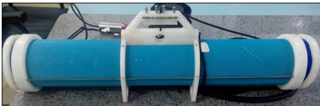
Figura 10 - Garrafa oceanográfica do tipo Van Dorn, utilizada nas coletas em profundidade
