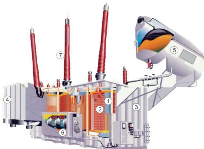
Figura 2 – Transformador de potência
