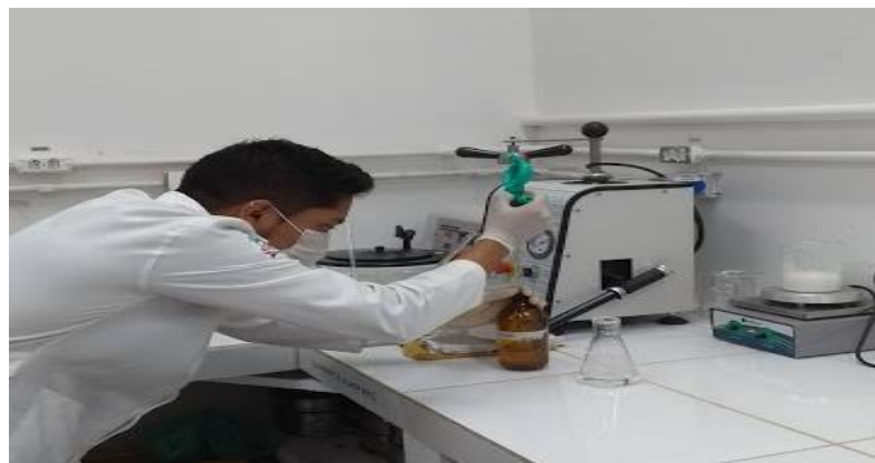
Figura 12 - Adição do ácido na solução de Ca(OH)_2
