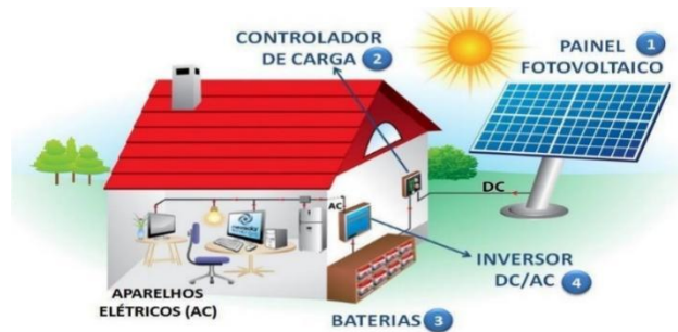
Figura 7 - Sistemas Autônomos ou isolados (off grid)
