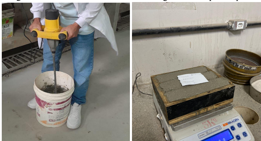
Figura 4 - Mistura dos materiais e moldagem dos corpos de prova.
