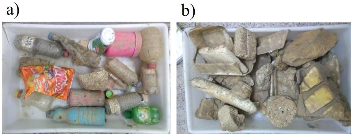
Figura 15 Resíduos flutuantes coletados no período de 2 horas nas ecobarreiras instaladas no rio Tucunduba. A) Resíduos diversos como plásticos (embalagens, rótulos, garrafas e outros); B) Diversidade de tipos de Isopor.
