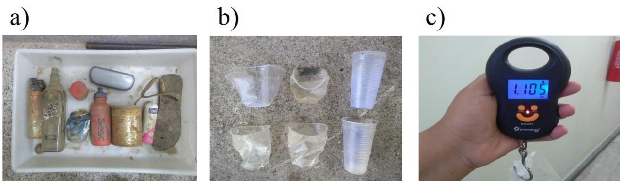
Figura 7. A) Processo de secagem dos resíduos flutuantes coletados com a ecobarreira tipo 1; B) Identificação e classificação dos resíduos coletados; C) Pesagem dos resíduos coletados após a secagem
