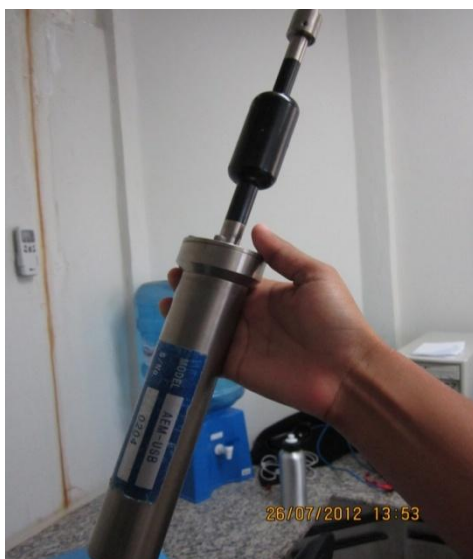
Figura 15- Correntômetro magnético (modelo AEM-USB).
