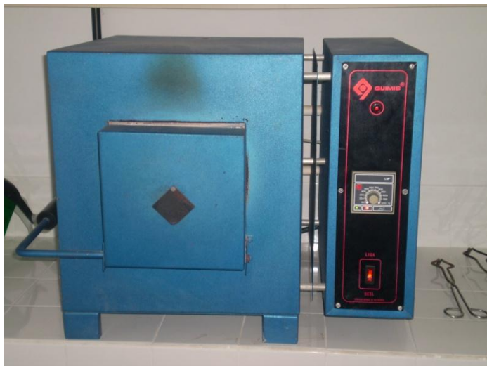
Figura 6 - Mufla utilizada na calcinação dos filtros para determinação do material particulado em suspensão (MPS).
