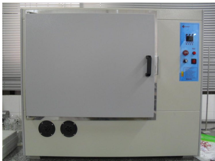
Figura 8 - Estufa utilizada para retirada de água dos filtros com o material retido.
