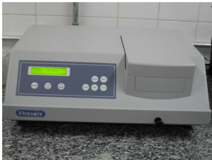
Figura 7 - Espectrofotômetro da marca BIOSPECTRO, usado para a determinação das clorofilas e seus produtos de degradação, e fosfato inorgânico dissolvido (PID).
