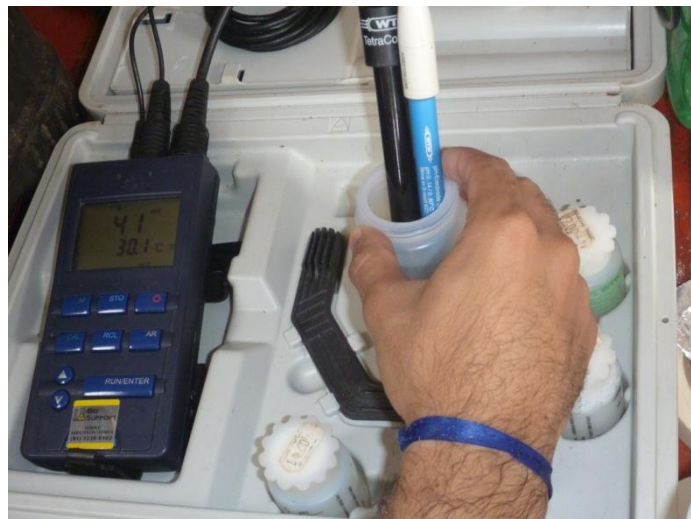
Figura 5 - Analisador multiparâmetros utilizado para obtenção dos parâmetros hidroquímicos.
