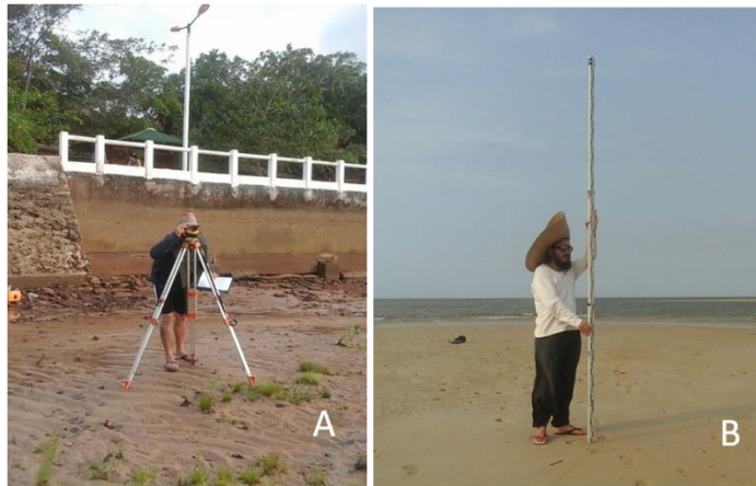
Figura 8- Equipamentos utilizados para realização dos perfis topográficos. Vista frontal do nível e tripé (A) e da régua (B).
