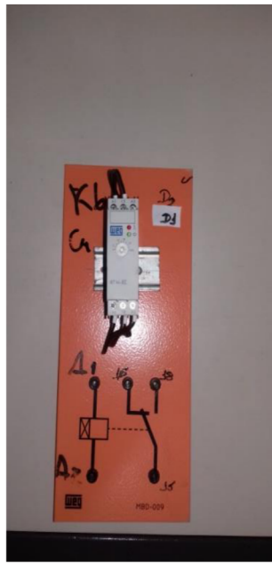
Figura 36. Relé temporizador WEG (RTW RE 0.1).
